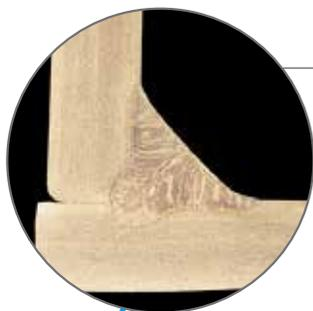
Cordão de soldadura MAG Ferromaxx® Plus em aço inoxidável AISI 316L de 6mm de espessura
