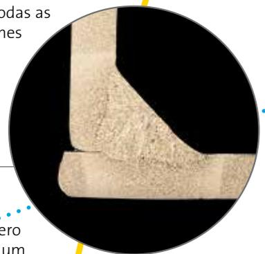
Cordão de soldadura MAG Ferromaxx® 7 em aço BS970:080M50 de 3mm de espessura
