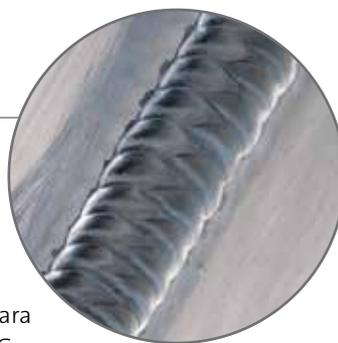
Soldadura topo a topo TIG em liga de alumínio 4140 de 10mm de espessura com Alumaxx® Plus
