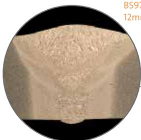
Soldadura MAG topo a topo Ferromaxx® 15 em aço BS970:080M50 de 12mm de espessura
